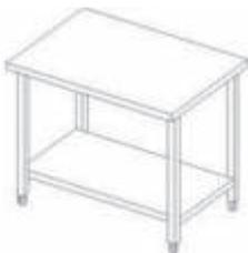
Piano di lavoro in acciaio AISI 304, spessore 10/10 con piega salvamani sui bordi e sottopiano. Ripiano inferiore in acciaio AISI 304 con bordo di 40mm, angoli rivettati con rinforzi trasversali in acciaio. Gambe quadre 40x40mm in acciaio AISI 304 con piedini in acciaio.
