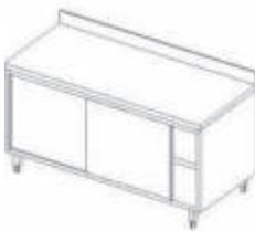
Costruito interamente in acciaio. Struttura interna saldata in acciaio. Connessione tra pannelli e struttura saldata brevettata. Piano di lavoro, alto 40 mm, in acciaio AISI 304, incorpora un materiale fonoassorbente ed è dotato di angoli arrotondati. Alzatina (h=100mm) con R=8mm. Porte scorrevoli fonoassorbenti. Maniglie incassate. Ripiano intermedio ad altezza regolabile con angoli rivettati e rinforzo in acciaio inox. Dotato di piedini ad altezza regolabile (-10/+60mm).
