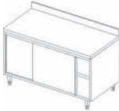
Costruito interamente in acciaio. Struttura interna saldata in acciaio. Connessione tra pannelli e struttura saldata brevettata. Piano di lavoro, alto 40 mm, in acciaio AISI 304, incorpora un materiale fonoassorbente ed è dotato di angoli arrotondati. Alzatina (h=100mm) con R=8mm. Porte scorrevoli fonoassorbenti. Maniglie incassate. Ripiano intermedio ad altezza regolabile con angoli rivettati e rinforzo in acciaio inox. Dotato di piedini ad altezza regolabile (-10/+60mm).
