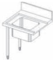
Per lavastoviglie a capottina. Costruita in acciaio inox 304 AISI. Paraspruzzi 300h mm. N. 2 gambe tubolari a sezione quadrata 40x40 mm su piedini regolabili. Dimensione vasca 500x400x300h mm con tubo troppo pieno, foro di scarico e sifone in plastica. Direzione cestello: Da sinistra a destra.
