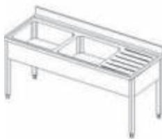
Piano di lavoro in acciaio AISI 304, spessore 10/10, con bordo anteriore a spigolo da 40mm. Alzatina h=100mm a spigolo, chiusa posteriormente. N.2 vasche 500x500mm. Pannellatura frontale e laterale in acciaio AISI 304, schienale in acciaio. Gambe quadre 40x40mm in acciaio AISI 304 con piedini in acciaio.
