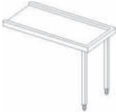
Per lavastoviglie a capottina. Costruita in acciaio inox 304 AISI. N. 2 gambe tubolari a sezione quadrata 40x40 mm su piedini regolabili. Direzione cestello: da destra a sinistra e da sinistra a destra.
